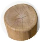
Das Robinienholz, das für die Herstellung der Robinierserie verwendet wird, enthält viele Öle, die das Material sehr gut vor Witterungseinflüssen schützen und es auf natürliche Weise vor Fäulniserscheinungen und Schädlingen bewahren. Bei der Beschaffung des Holzes können wir sicher sein, dass es aus europäischen Plantagen mit FSC®-Zertifizierung und anderen kontrollierten Quellen stammt, dank derer wir im Sinne einer nachhaltigen Entwicklung für die Zukunft sorgen.
